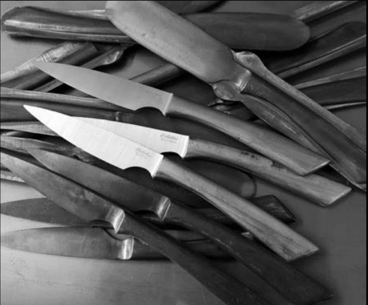
*I nostri coltelli hanno la lama forgiata, che viene ricavata da un tondo di acciaio, che subisce un appiattimento, ad alte temperature, da un maglio che sviluppa un colpo di 1200 tonnellate. La lama che durante il processo di forgiatura diventa più compatta, viene poi assottigliata e temperata, per essere poi montata sul manico grazie ad un codolo a scomparsa e successivamente rifinita manualmente, compresa l'affilatura.*
